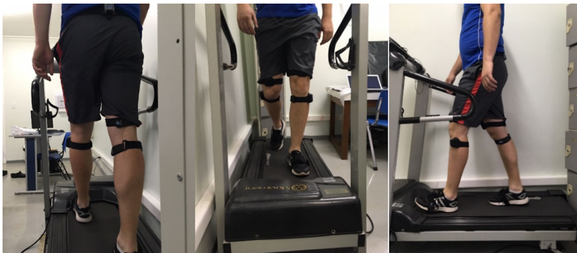
Figura 1- Vista posterior, anterior e lateral do posicionamento dos sensores da avaliação tridimensional da marcha.
